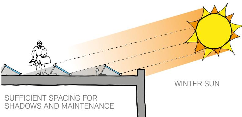
SUFFICIENT SPACING FOR SHADOWS AND MAINTENANCE
